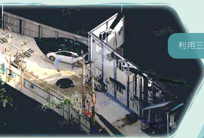
利用三維激光掃描儀掃描製作的錦田地盤寫字樓3D圖
